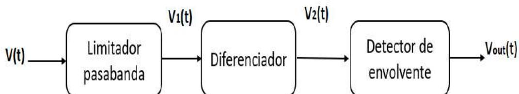
**Figura 1. 29:** Demodulación en frecuencia utilizando detección de pendiente.
